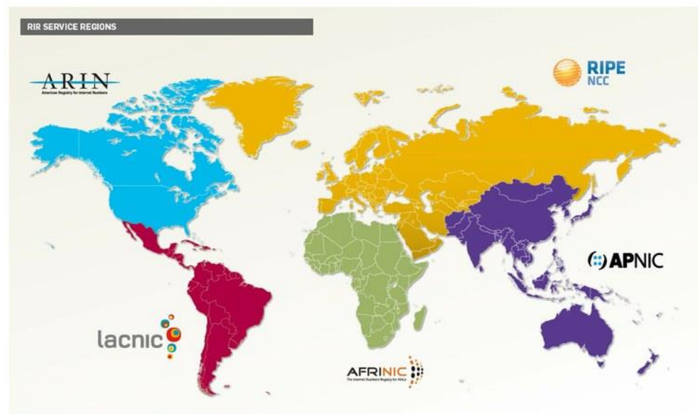
Figuur 2: Overzicht van de vijf Regional Internet Registries (RIR) en het gebied dat zij bedienen 21 .
